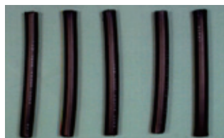
試験結果ケーブルサンプル (左：600V M-CV、右：無添加)
