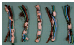
試験結果ケーブルサンプル (左：600V M-CV、右：無添加)
